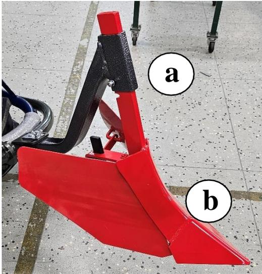
Abb. 1-6 In die Halterung des Universalträgers die Halterung der Schar (a) einsetzen und mit Stift, Schraube, zwei Unterlegscheiben und Flügelmutter sichern, die im Zubehör des Universalträgers enthalten sind.
